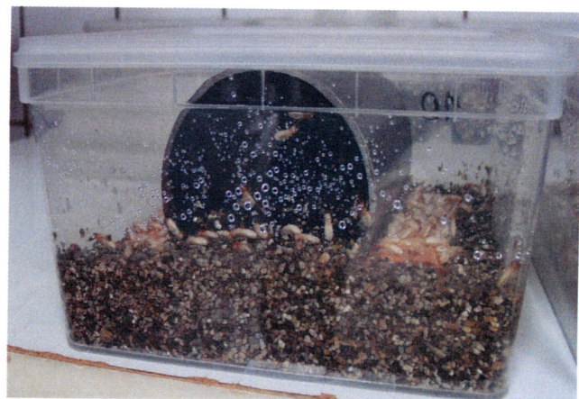
Abb. 3: Exposition der Prüfkörper FiloSeal+HD Duct Seal (oben links) und MDIII 75n Duct Seal (oben rechts) gegenüber Mastotermes darwiniensis , sowie Virulenzkontrolle (unten links)
